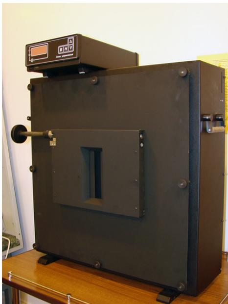
Рис. 3. Протяженный излучатель ПЧТ-540/40/100, «Эталон»
