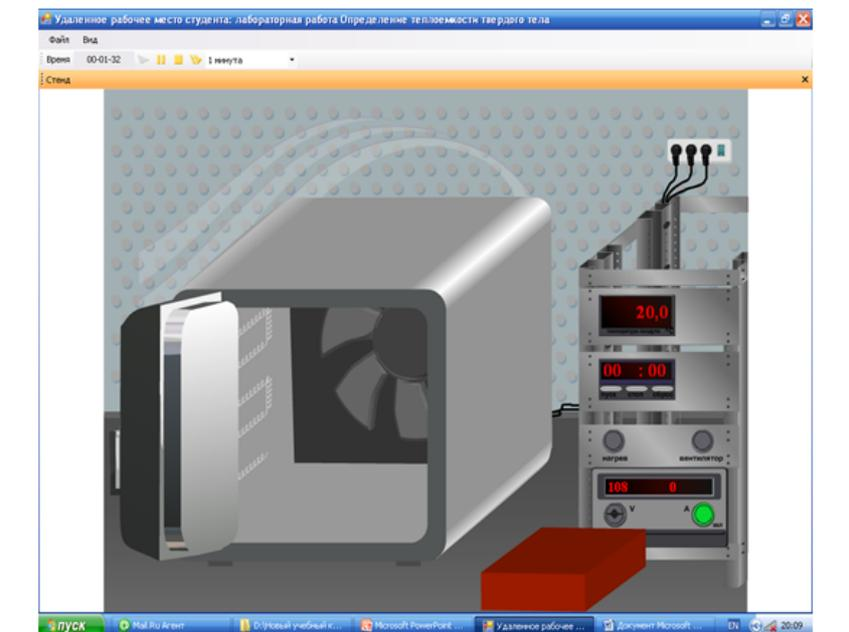
Рис. 1. Вид виртуальной лабораторной установки по определению теплоемкости конструкционных материалов
