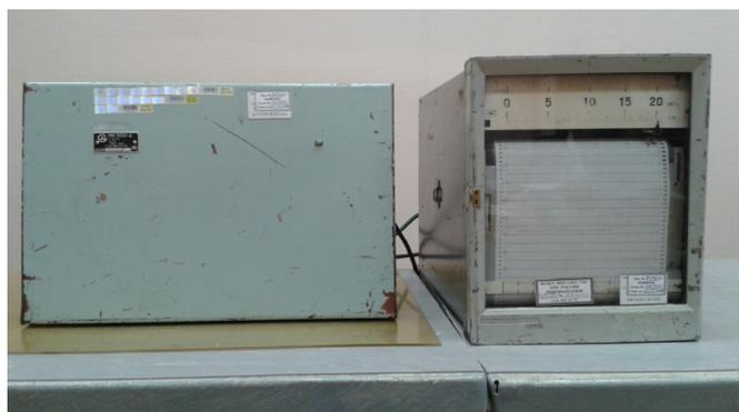
Рис. 1. Газоанализатор O<sub>2</sub> МН-5130 и вторичный прибор КСУ-2
